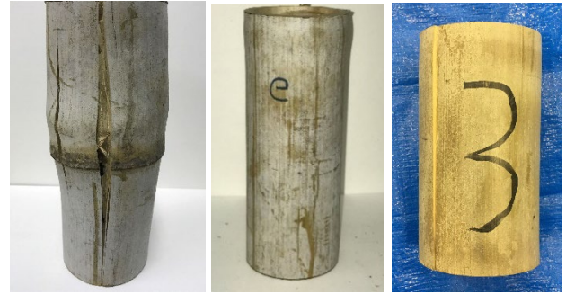
写真 2 試験体 (単調荷重圧縮実験後)
