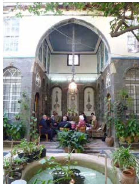
図4: 中庭に面した半戶外空間のイーワーン イーワーンは太陽を背にして日陰を作り、噴水と対をなして、夏の居間のように使われる
