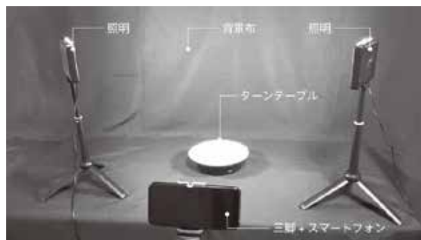
図 4 小型の建築模型を撮影する際の機材の構成
