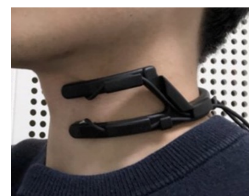
生体音収録用 皮膚接触型マイク
